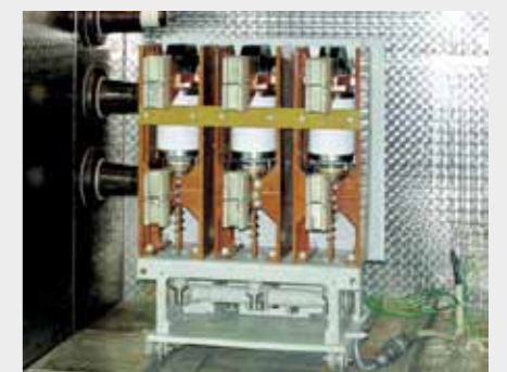
Испытание выключателя ВРЗ в климатической камере
